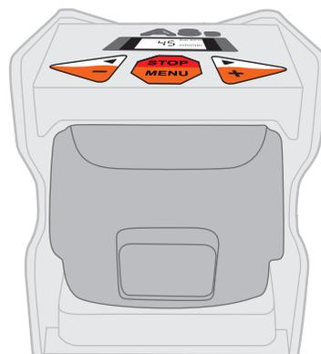
Per installare la batteria, premerla saldamente nell'alloggiamento posto davanti al carrello.
