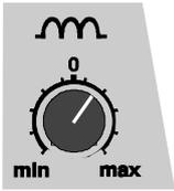
Indstilling af MIG-svejsedynamik påvirker svejsningens stabilitet og mængden af sprøjt. Nulstilling anbefales som grundindstilling. Værdien → min. (-1...-9), blødere bue for at mindske mængden af sprøjt. Værdien → max. (1...9), grovere bue for at øge stabiliteten og ved anvendelse af 100 % CO<sub>2</sub> beskyttelsesgas ved svejsning af stål.
