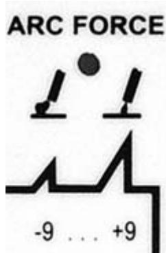
Velg buetrykk ("Arc Force") ved hjelp av pilknappene (6). Den tilsvarende indikatorlampen (7) vil lyse, og en av følgende tallverdier vil bli vist i display 5: -9...0...+9. Om nødvendig kan du regulere lysbuen med potensiometeret for innstilling av sveiseparametre (4): -1...-9 for mjukere lysbue, +1...+9 for hardere.
