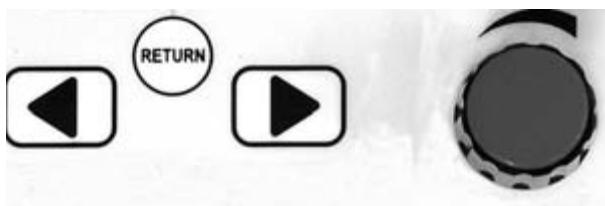
For å velge sveiseparametre trenger du bare å bruke de to knappene "venstre-pil" og "høyre-pil" (6). Regulering foretas med potensiometeret (4). Ved å trykke "RETURN"-knappen går du fra parameterregulering direkte tilbake til sveisestrøm. Displayet (5) viser automatisk numeriske verdier og parameterenheter. Under reguleringen av parametrene vil du kunne se verdiene på det numeriske displayet. Etter 10 sekunder går displayet tilbake og viser sveisestrømmen.
