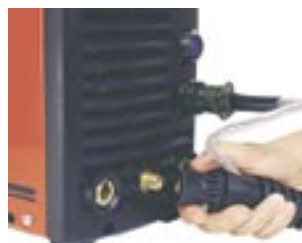
Installering af brænder
