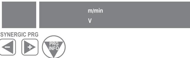
Die Programmnummer der Rundung wählen Sie mit den plus-minus Tasten. Es wird im Display unter "SYNERGIC PRG" angezeigt.
