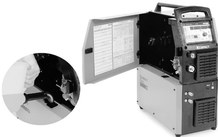
Riempire il serbatoio con una miscela al 20-40% di etanolo e acqua, o con un altro antigelo appropriato. Il serbatoio ha una capacità di 3 litri.
