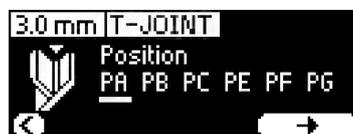
3. Weld Assist fornisce una raccomandazione per questi parametri di saldatura:
