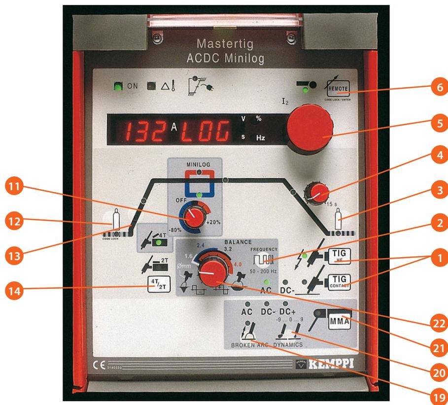
1. Interruptores selectores para soldadura TIG: TIG HF = TIG por chispas y TIG CONTACT = TIG por contacto
