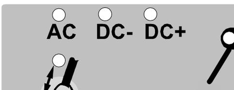
Seleccione la soldadura MMA pulsando la tecla de selección de soldadura MMA. La luz indicadora del tipo de corriente indica el tipo de corriente seleccionada. AC, DC-, DC+.
