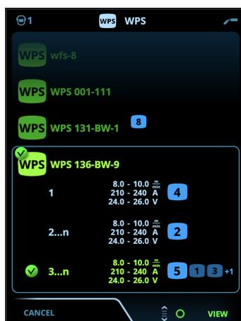
**i** Wenn eine dWPS und eine Schweißlage bereits mit dem aktiven Speicherkanal verknüpft sind, wird diese Schweißanweisung direkt in der Ansicht **WPS** geöffnet. Um die Liste der verfügbaren dWPS zu öffnen, die Option „WPS ändern“ wählen.
