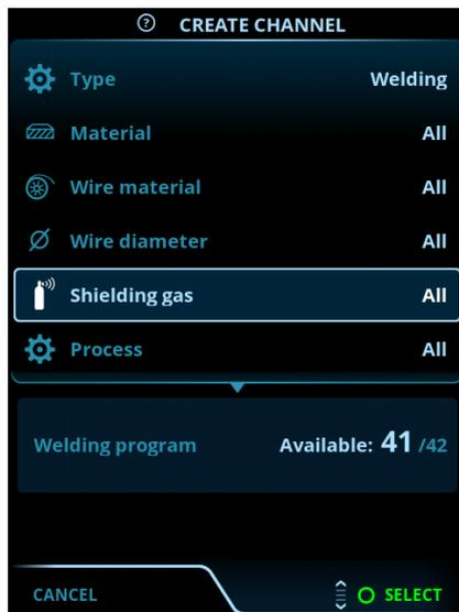
4. Nur MIG: Verwenden Sie die Filteroptionen (z.B. Material, Drahtmaterial oder Drahtdurchmesser), um die für den Zweck am besten geeigneten Schweißprogramme zu finden.
