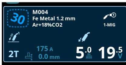
**Tip:** Geänderte Schweißparameter können schnell auf dem aktiven Speicherkanal gespeichert werden. Dazu die Taste Speicherkanäle etwa 2 Sekunden lang betätigen. Dies funktioniert in jeder Ansicht.
