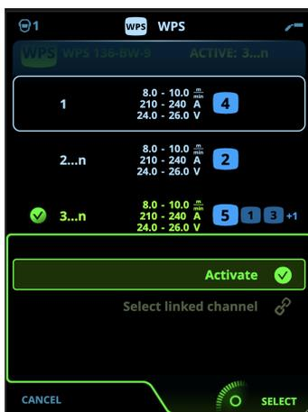
4. Wenn noch kein Speicherkanal mit der Schweißlage verknüpft ist, kann diese mit einem gegebenen Speicherkanal verknüpft werden („Verknüpften Kanal auswählen“).
